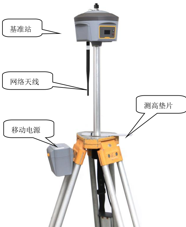
内置 GPRS 或 GPRS/3G 模块基准站示意图
